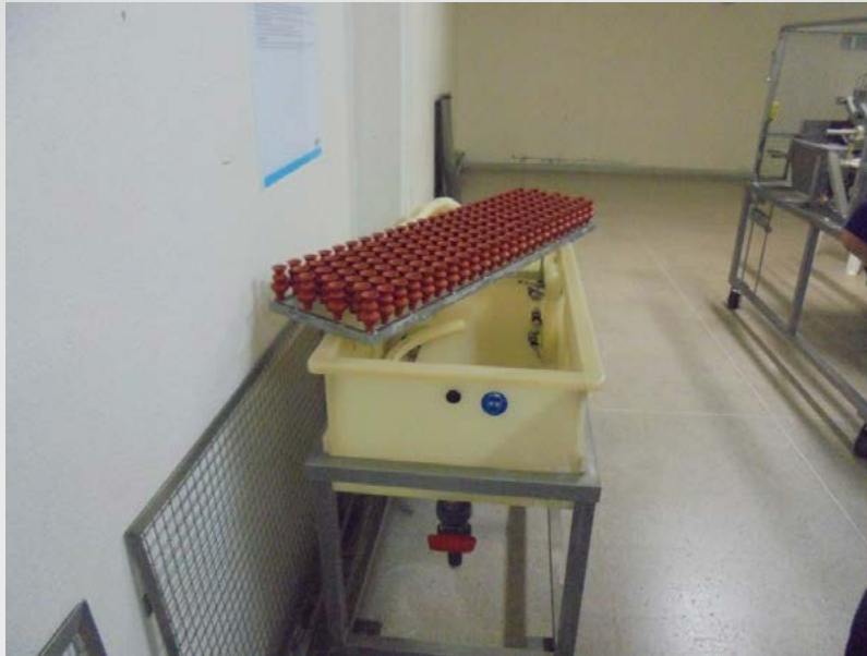
Figura 38. Sistema de copas de caucho al vacío para traslado de los huevos a otras bandejas
