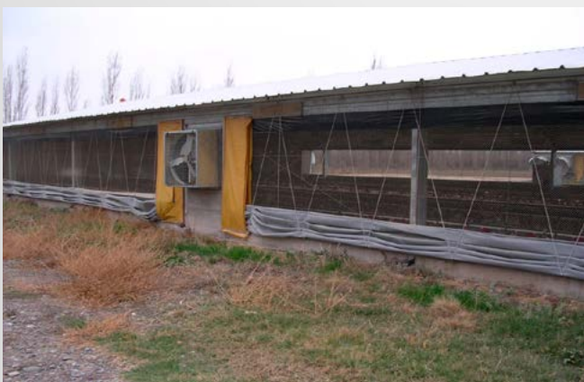
Figura 19. Galpón abierto con cortinas en lona, sistema de ventilación y extractor
