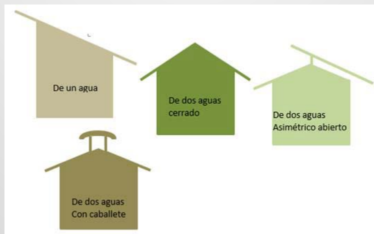
Figura 30. Tipos de cubiertas para galpones avícolas
