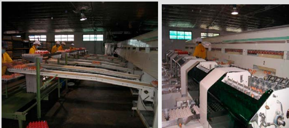
Figura 69. Clasificadora de huevos fértiles en una empresa de incubación
