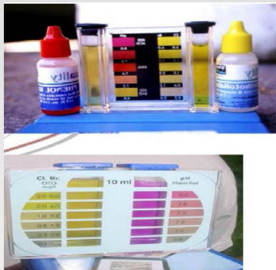
Figura 23. Kits para evaluación rápida de calidad física del agua en los bebederos
