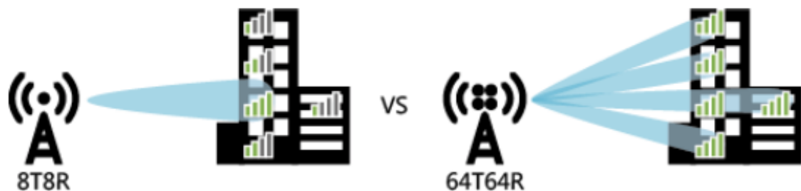
Figura 8. Cobertura Multipisos Massive MIMO. [2]
