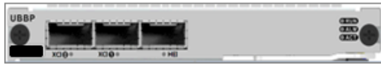
Figura 7. Tarjeta UBBP implementada. Tomado de: support.huawei.com
