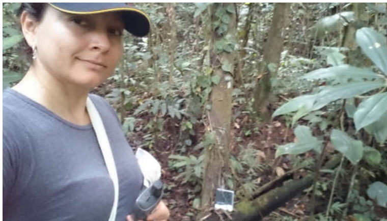
Figura 8. Medición de la temperatura ambiente y la humedad relativa. Ubicación del termohigrómetro, expuesto durante tres minutos
