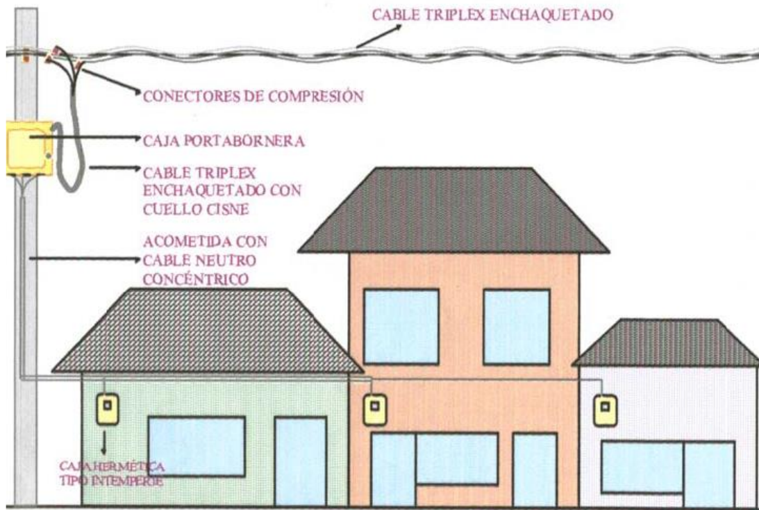
Gráfico ilustrativo 3. Instalación de redes domiciliarias de energía
