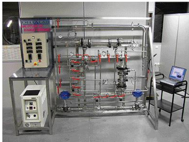
Figura 25 Banco de pruebas didáctico MP100 de transferencia de calor. Fuente: [28]
