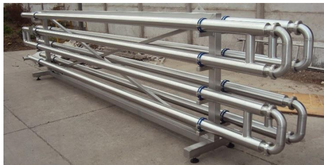
Figura 3 Intercambiador de calor de tubos concéntricos industrial. Fuente: [12]
