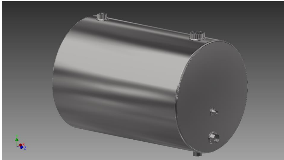
Figura 40 Tanque de calentamiento de aceite. Fuente: Autor
