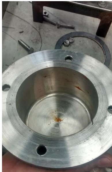
Figura 52 Revisión interna de los cabezales del intercambiador de coraza y tubos. Fuente: Autor
