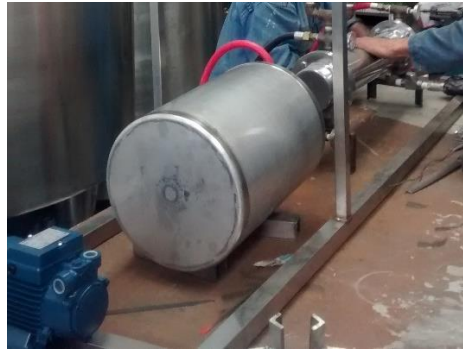
Figura 51 Tanque de almacenamiento de aceite recién soldado. Fuente: Autor
