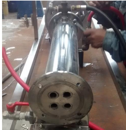
Figura 53 Estado de los tubos internos dentro de la coraza. Fuente: Autor
