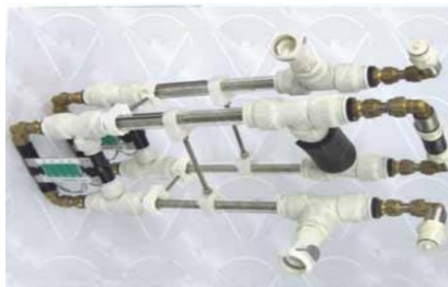
Figura 24 Intercambiador de calor de tubos concéntricos P.A Hilton H101E. Fuente: [27]
