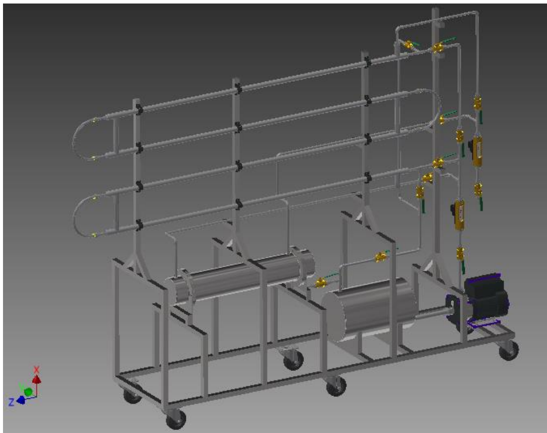
Figura 49 Ensamble del banco de pruebas de transferencia de calor. Fuente: Autor
