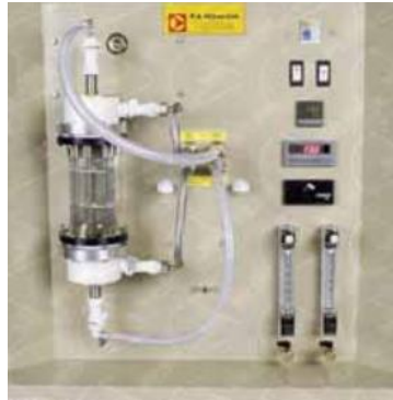
Figura 23 Base de servicios H101 para intercambiadores de calor. Fuente: [27]
