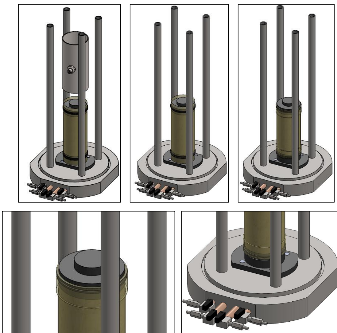
Ilustración 6.9: Procedimiento para montaje de muestra paso 9. Fuente: Propia
