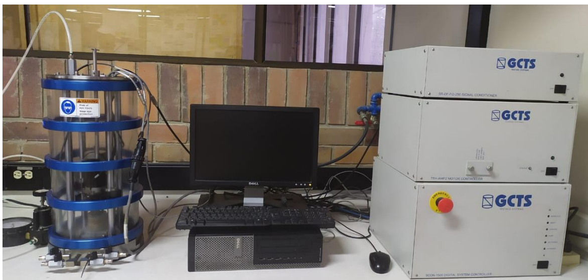
Ilustración 4.9: Montaje completo del equipo TSH-100. Fuente: Propia
