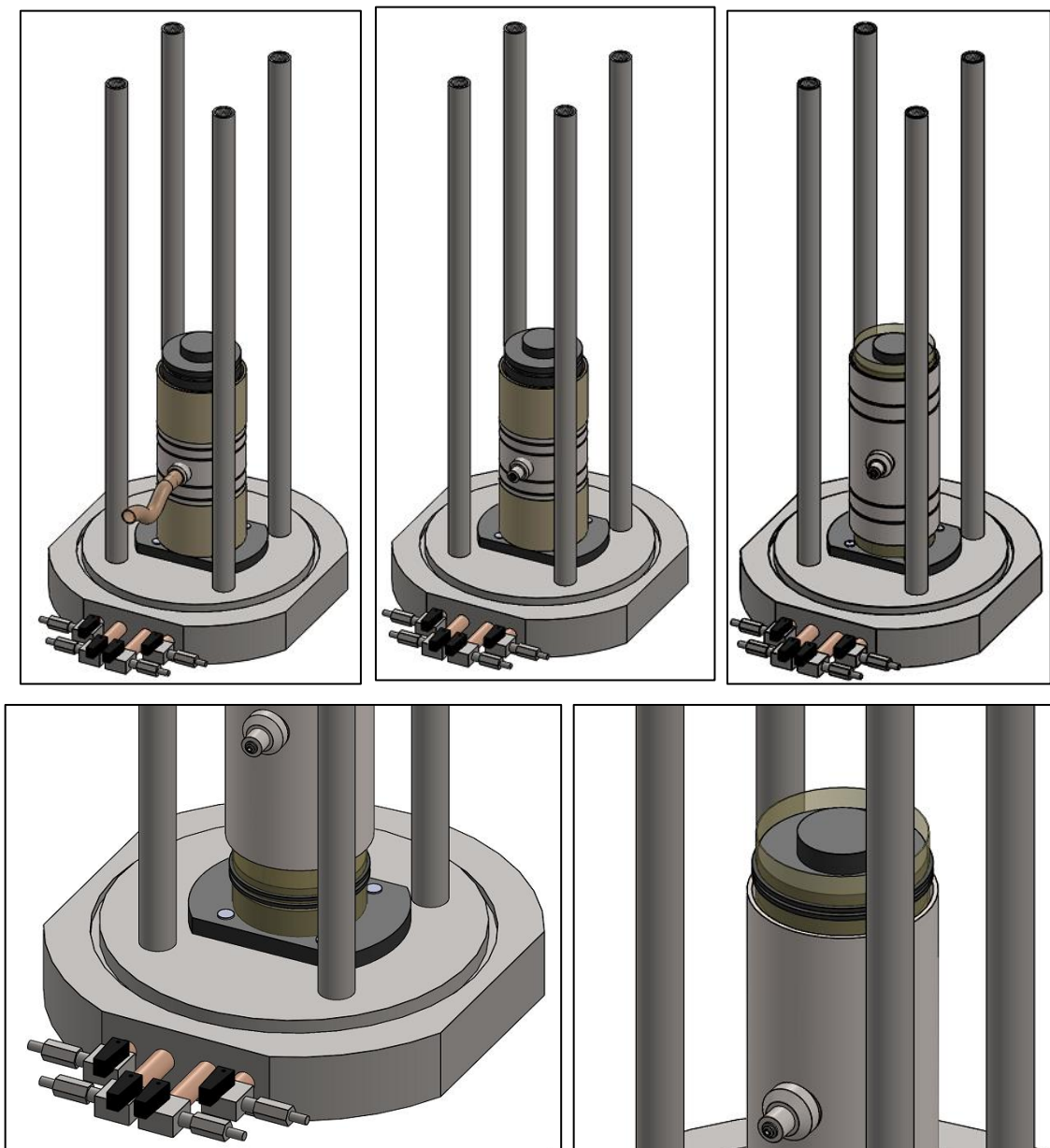
Ilustración 6.8: Procedimiento para montaje de muestra paso 8. Fuente: Propia
