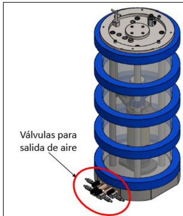
Ilustración 5.2: Desmonte de equipo TSH-100 paso 3. Fuente: Propia
