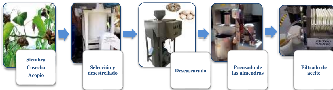
Figura 1. Proceso productivo del Sacha inchi por prensado en frío
