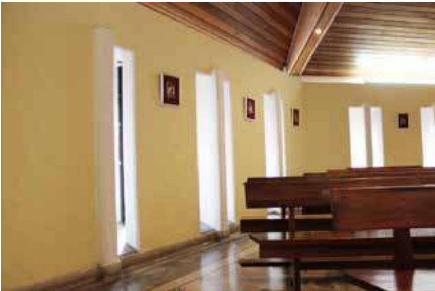
Figura 156. El protagonismo del borde “fuerte” se observa en el manejo de muros en la iglesia anglicana en Bogotá dado que éstos responden a un diseño muy elaborado, que en un juego de doble muro, genera una iluminación lateral indirecta y controlada gracias a los vanos verticales, que se abren alternadamente en el muro semicircular que cierra el espacio.
