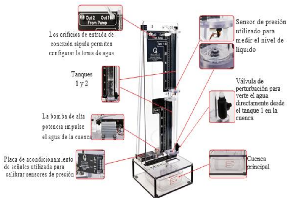
Figura 2. Descripción grafica de la planta y sus componentes planta tomado de infomation sheet of Quanser [10].
