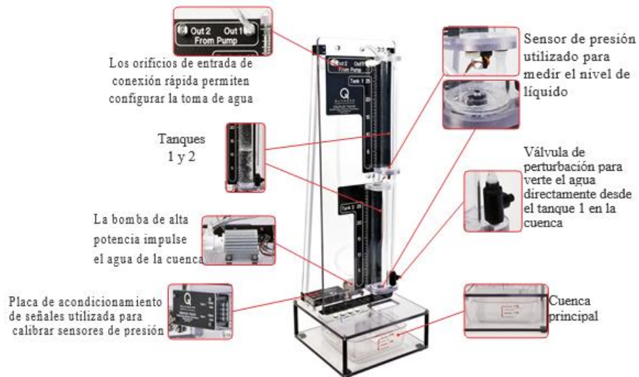
Figura 3. Descripción grafica de la planta y sus componentes tomado de [10].
