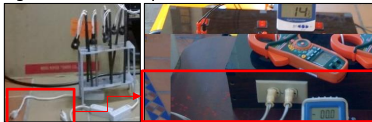
Figura 9. Resistencias y conectores al tablero de control.
