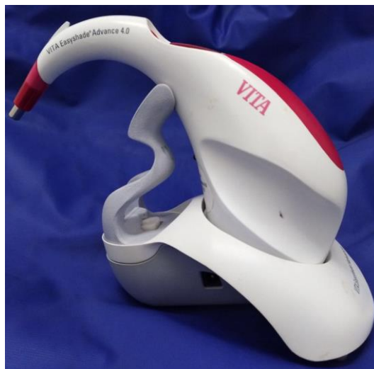
Figura 6. VITA Easy Shade Compact para toma de color
