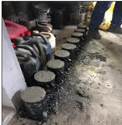
Ilustración 12. Muestras de concreto hidráulico
