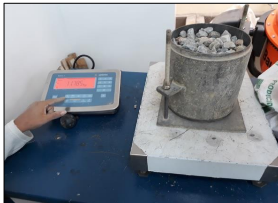
Ilustración 8. Caracterización del agregado grueso
