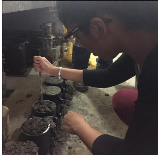
Ilustración 11. Golpes en cada capa para cada cilindro
