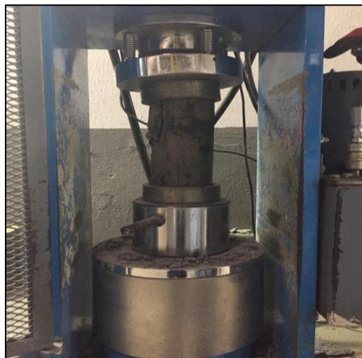
Ilustración 14. Falla del cilindro
