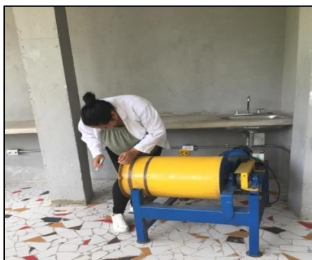
Ilustración 7. Molienda de la ceniza de cascarilla de arroz
