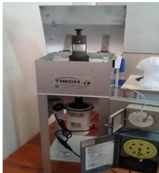
Figura 3. Instalación del kit de Calibración en el equipo, por: Tejeiro, Buitrago, 2018
