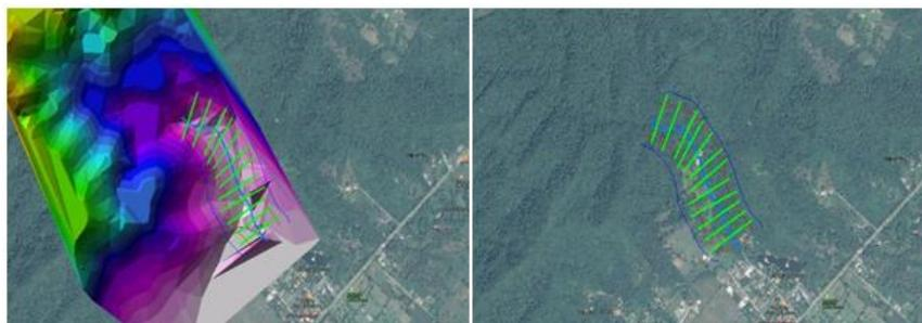
*Figura 18.* Secciones transversales generada en el programa HEC-GEORAS
