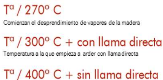
Figura 3. Temperatura de ignición con y sin llama directa Fuente: Reinprecht (2016).
