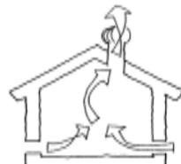
figura 15 [H6] Enfriamiento por túnel de ventilación subterránea [Bansal 1994]
