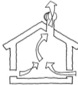
figura 15 [H6] Enfriamiento por túnel de ventilación subterránea [Bansal 1994]
