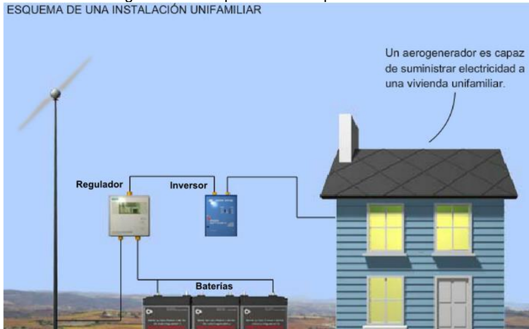
Figura 10.1. Esquema de componente eólico
