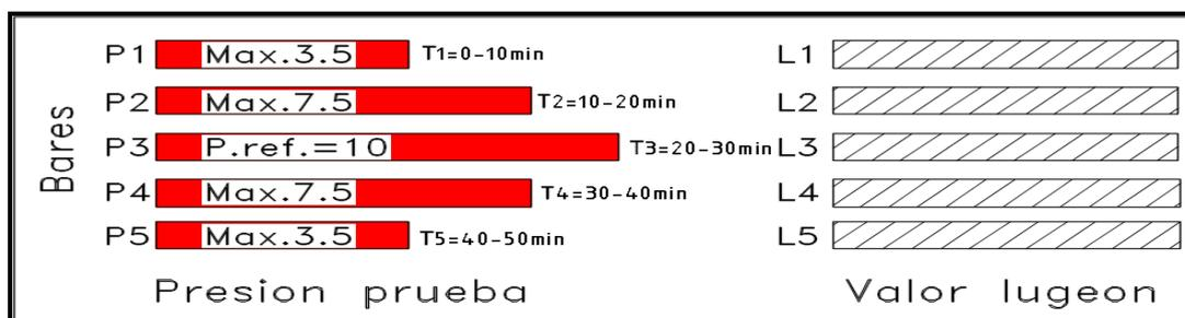
Figura 49. Prueba de lugeon. Caso flujo laminar. Fuente: Elaboro Autor. Adaptado de U.S. Army Corps of Engineers. 15.17-15.21.
