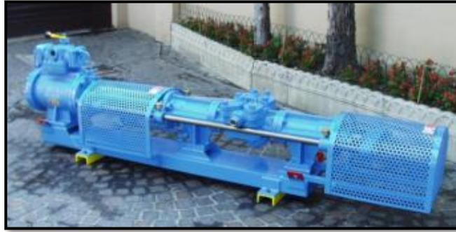
Figura 58. Bomba Neumática tipo pistón. Fuente: (TECOP, 2019)
