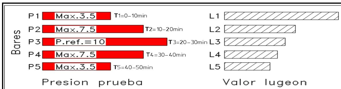
Figura 53. Prueba de lugeon. Caso obstrucción con rellenos. Fuente: Elaboro autor. Adaptado de U.S. Army Corps of Engineers. 15.17-15.21.
