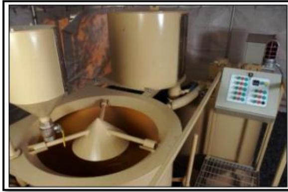
Figura 57. Equipo dispensador de aditivos. Hany HCM. Fuente: (Weaver, Dam Foundation Grouting , 2007).
