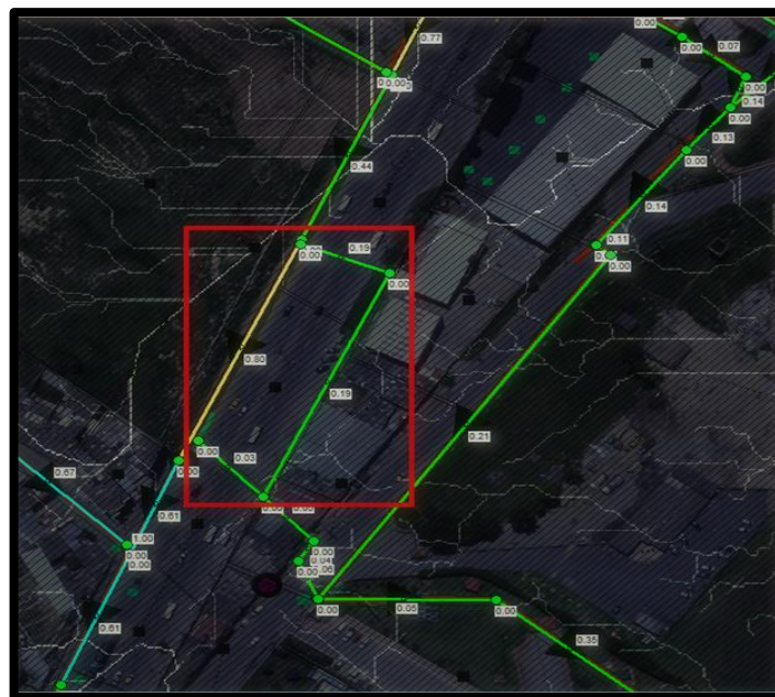
Figura 31 Tubería de diseño planteada para dar solución a la inundación en el distrito Soaquira
