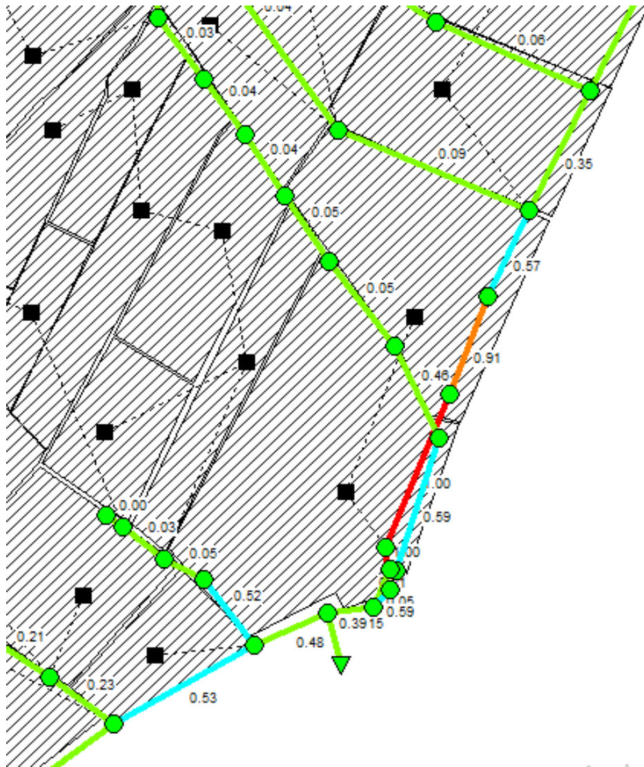
Figura 34 Identificación de zonas las cuales excedieron su capacidad en el tramo identificado
