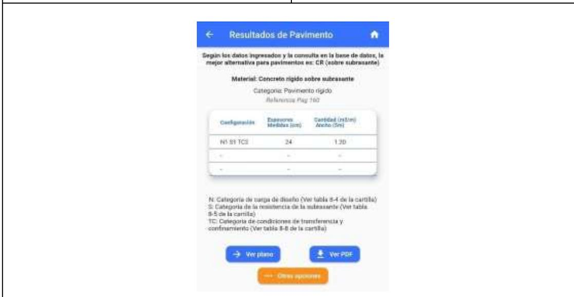
Como resultado nos muestra que es viable una construcción de pavimento rígido sobre la subrasante
