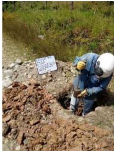
Apique No. 4 K0 + 600 Ensayo de Penetración Dinámica
