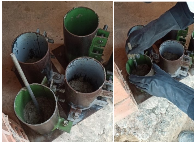
Ilustración 42. Apisonado de concreto
