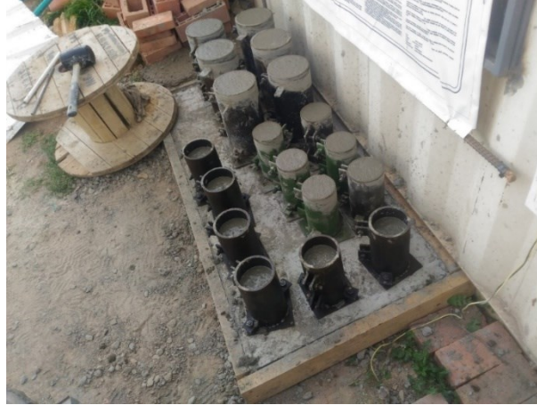
Ilustración 46. Muestras de cilindros de concreto terminados
