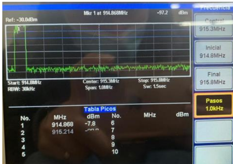
Figura 63 Medición de la potencia en la frecuencia de 914.9MHz al enviar de un paquete LoRa 20 centímetros de distancia entre el gateway y el nodo LoRa-GPS sin obstáculos [Autor].
