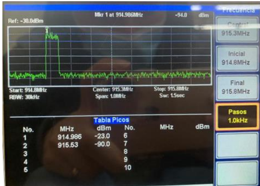
Figura 62 Medición de la potencia en la frecuencia de 914.9 MHz al enviar de un paquete LoRa 5 metros de distancia entre el gateway y el nodo LoRa-GPS con obstáculos [Autor].
