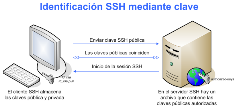
Fig.2. Funcionamiento del protocolo SSH (Identificación SSH mediante clave)- Imagen tomada de: http://katherynnparedes.blogspot.com.br/2013/04/tipos-de-protocolo.html
