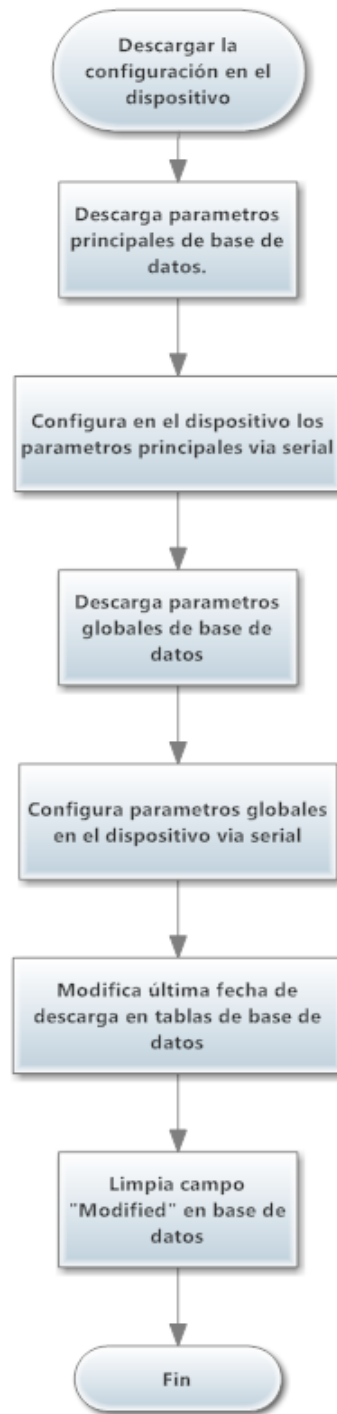
Fig. 11. Diagrama del proceso de descarga de configuración.
