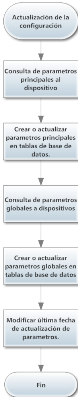
Fig. 10. Diagrama del proceso de actualización de configuración.
