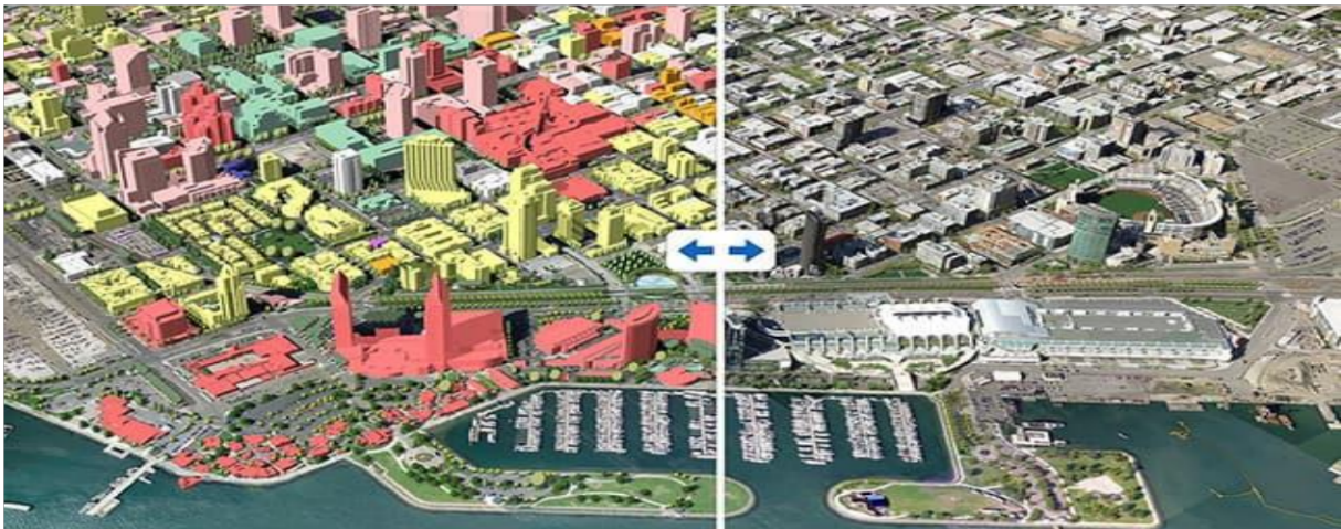
Ilustración 10 Gemelo digital urbano con City engine, comparativo de gemelo digital base + temático aplicado a las construcciones fuente https://www.aeroterra.com/es-ar/productos/esri-cityengine/introduccion .
