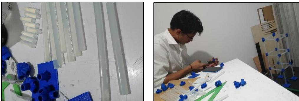
Figura N°12. Barras de silicona y uniones en PLA.
