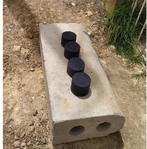
Fotografía 32. Elaboración de briquetas Marshall. Fotografía 33. Briquetas Marshall.
