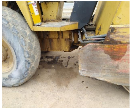
Fotografía 5. Fuga vibro compactador
