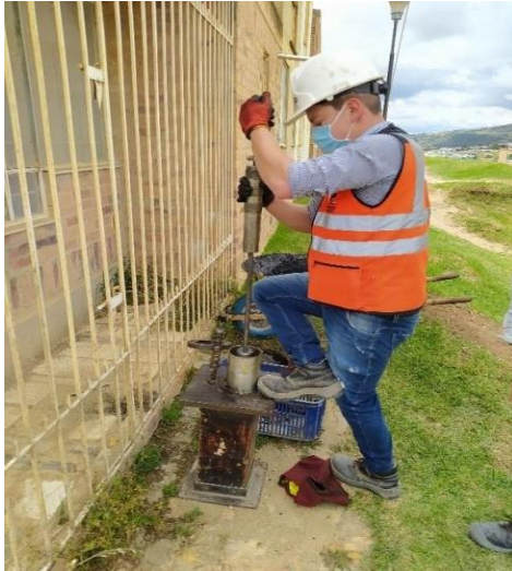
Fotografía 32. Elaboración de briquetas Marshall. Fotografía 33. Briquetas Marshall.
