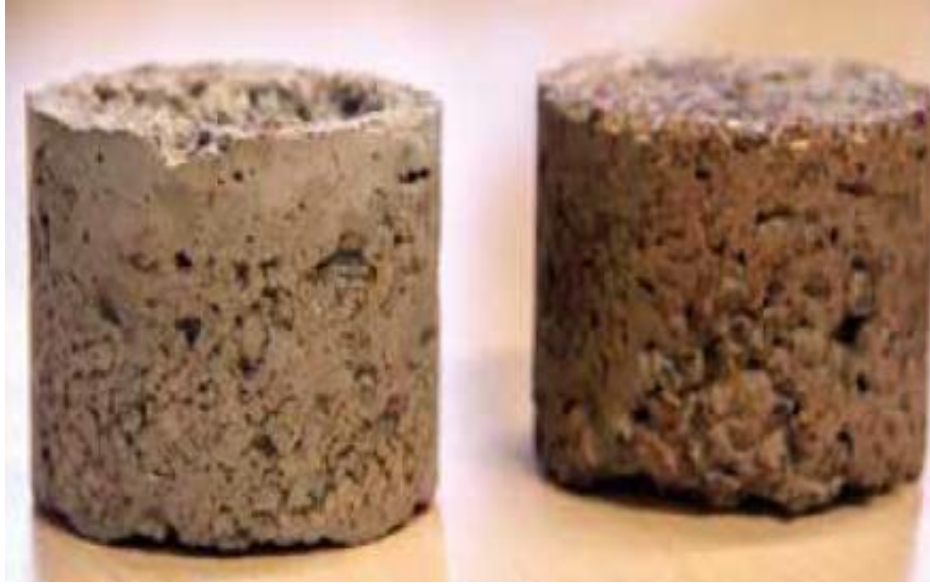
Figura 6. Material laterítico estabilizado al 2% (derecha) y 4% de cemento hidráulico (izquierdo).
