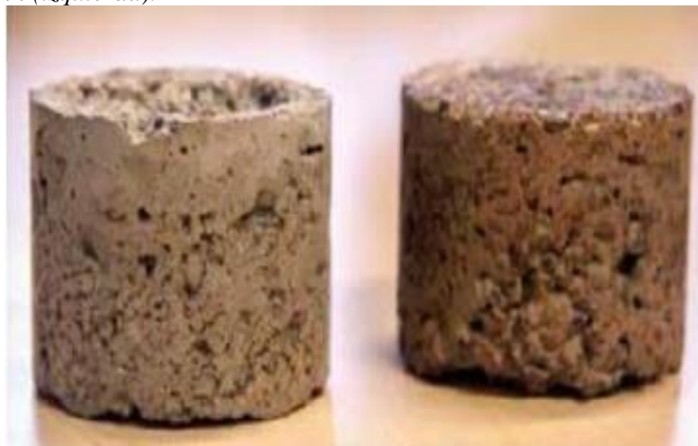
Figura 10. Fotografías de las pruebas del material laterítico que se estabilizó con cemento hidráulico al 2% (derecha) y al 4% (izquierda).
