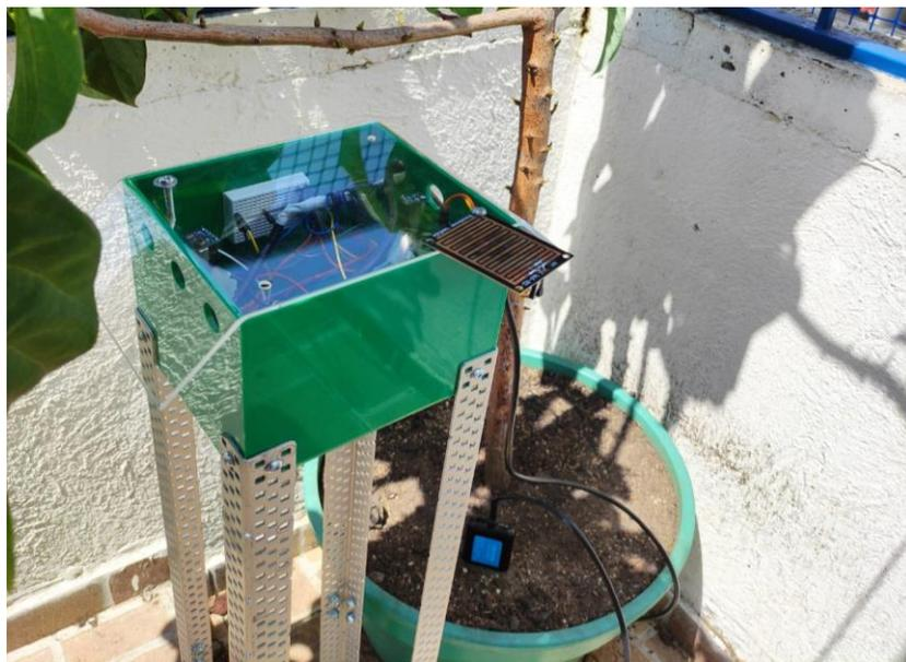
*Nota:* una vez terminada la estructura con su respectiva distribución de sensores al interior se procedió a una fase de pruebas en donde el enfoque de calibración se debió realizar específicamente en el sensor de pH, puesto que su información a detalle se encuentra en idioma mandarín.
