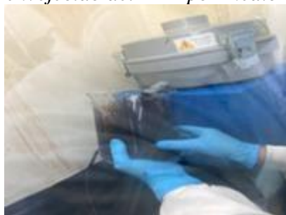
Figura 3. Extracción del asfalto envejecido del RAP por medio de la centrifuga.
