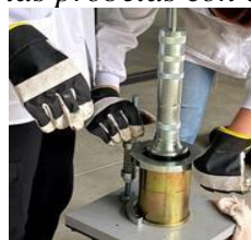
Figura 13. Aplicación de los golpes de las probetas con el martillo de compactación.
