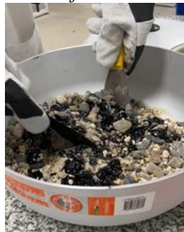
Figura 11. Mezcla de los agregados con el asfalto.
