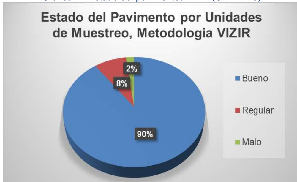
Gráfica 17 Estado del pavimento, VIZIR (CARRIL 3)
