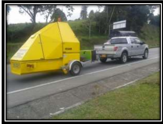
Fotografía 3 FWD - (DEFLECTÓMETRO DE IMPACTO) (Itineris S.A.S)
