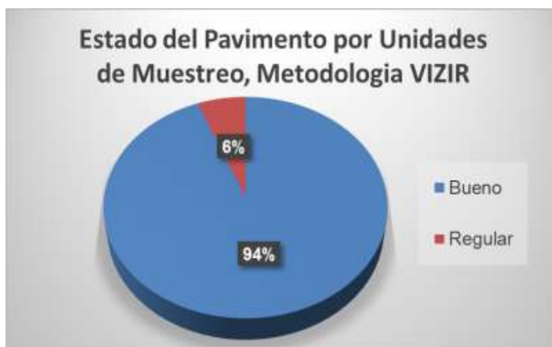
Gráfica 19 Estado del pavimento, VIZIR (CARRIL 4)
