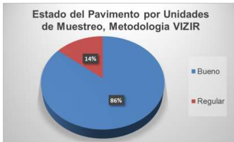
Gráfica 21 Estado del pavimento, VIZIR (CARRIL5)
