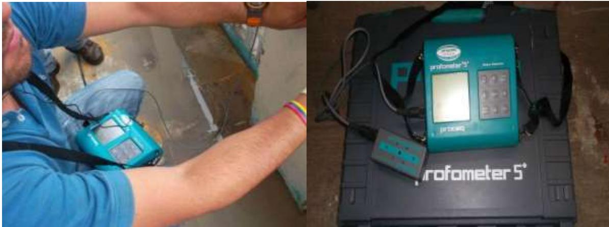
**Escaneo de columnas para detección de refuerzo**
