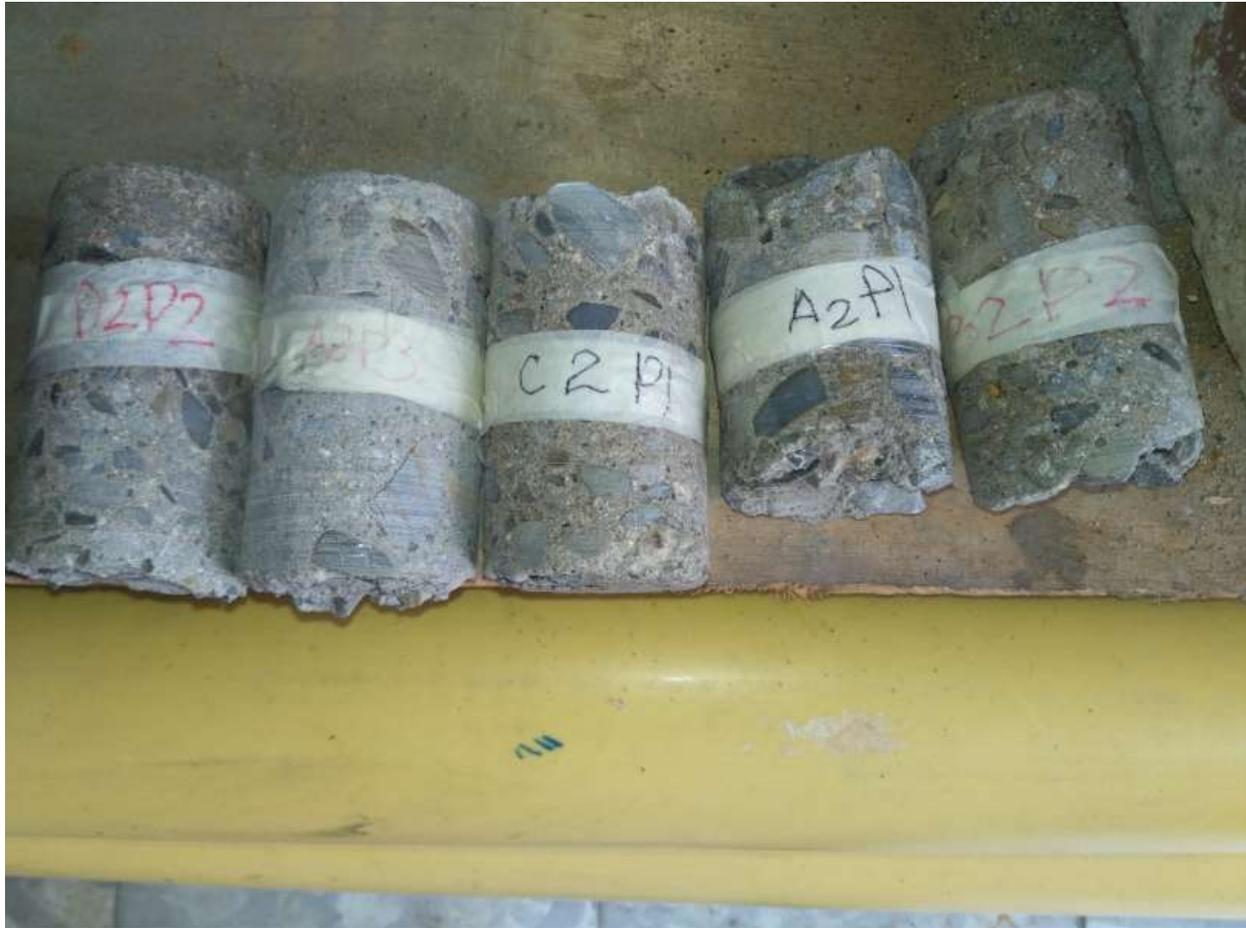
***Muestras para medir la resistencia de los concretos***
