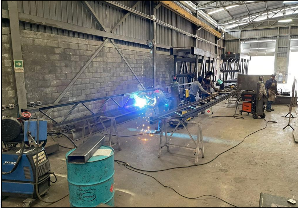
FIGURA 20. Supervisión de soldada de joist
