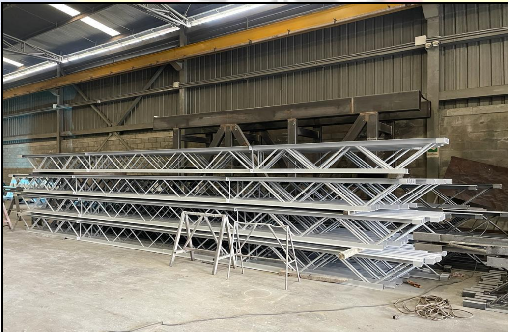
FIGURA 21. Supervisión de joist de mezanine
