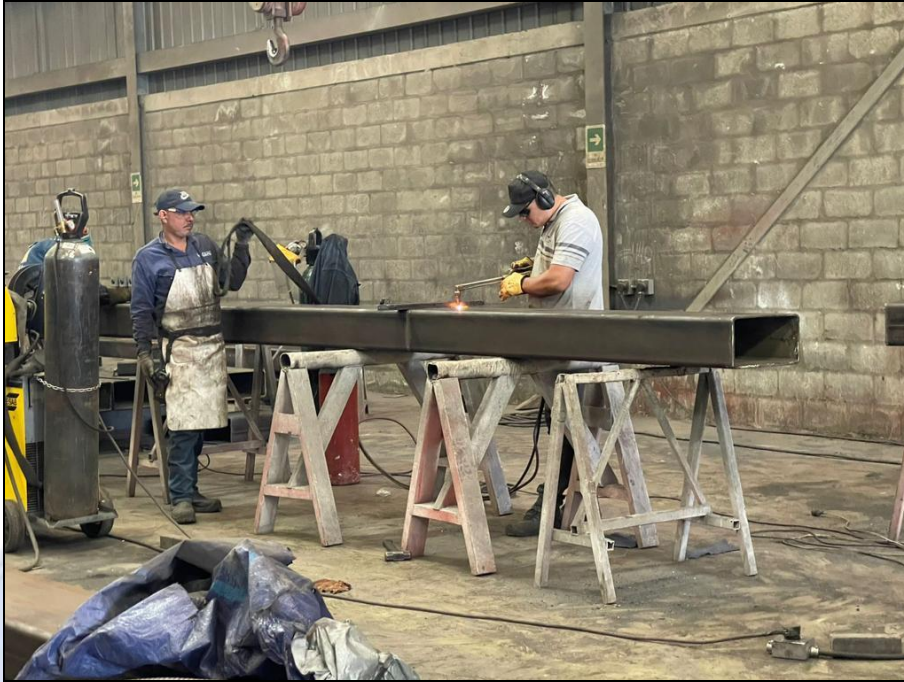
FIGURA 10. Supervisión de corte de perfiles rectangulares con oxicorte
