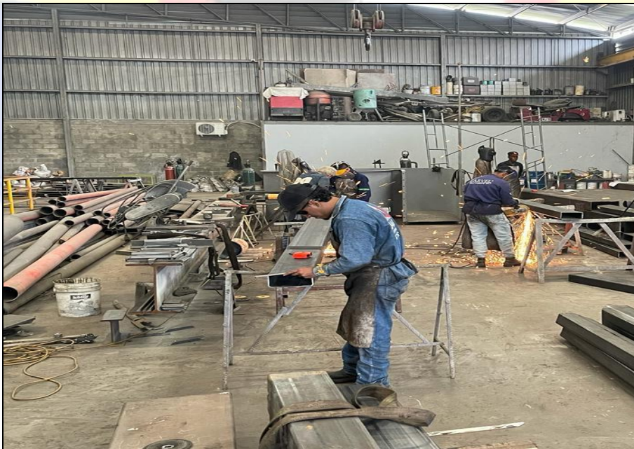
FIGURA 11. Supervisión de corte de perfiles rectangulares con pulidora
