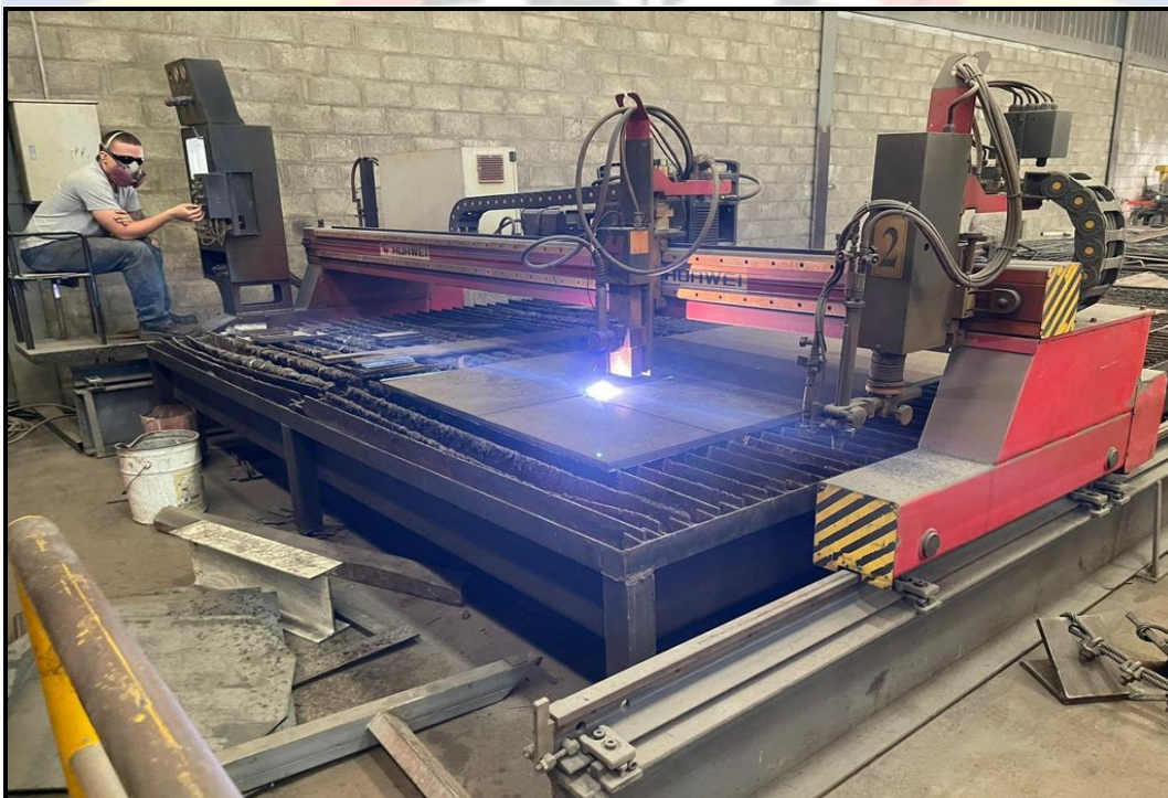
FIGURA 33. Supervisión de corte de platineria con maquina cnc plasma
