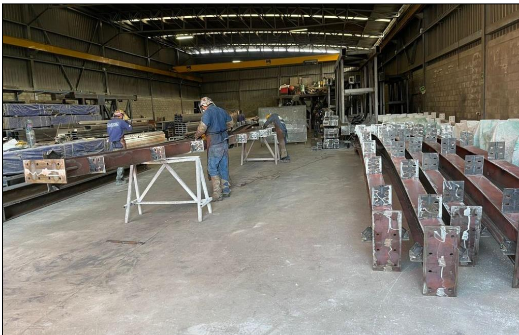
FIGURA 7. Supervisión de limpieza de cerchas
