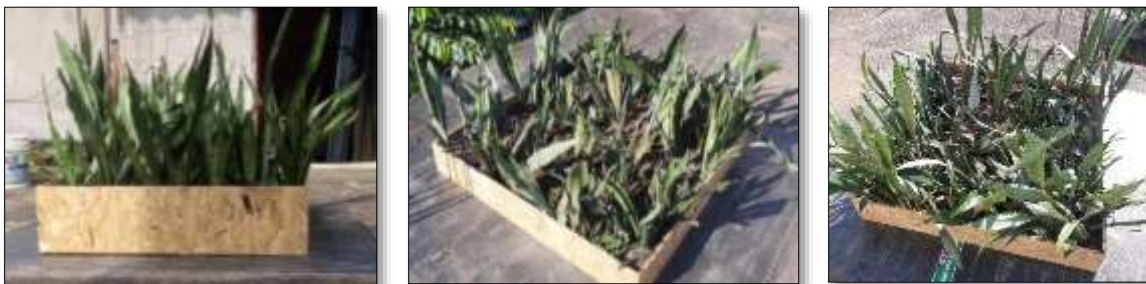
Figura 11. Visualización del modelo intensivo de 25 cm, modelo semi-intensivo de 15 cm y modelo extensivo de 5 cm finalizado
