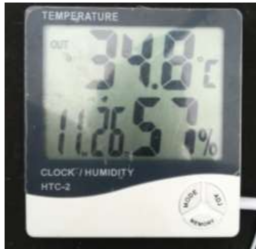
Figura 13. Termómetro higrómetro usado para tomar las temperaturas y humedades relativas
