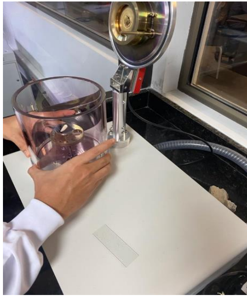
Figura 2. Muestra ubicada en el pin para su recubrimiento
