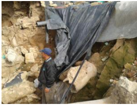
Arcillolita en el escarpe del movimiento de remoción y presencia de roca arenisca. Fuente: Elaboración propia.
