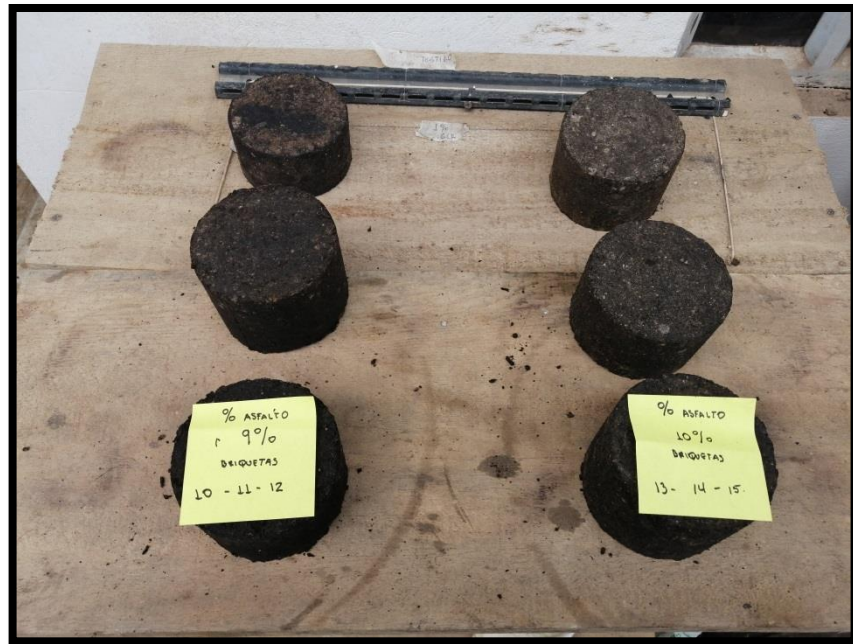
Figura 43. Briquetas de Mezcla Asfáltica Natural, con porcentajes de 9% y 10% de asfalto.
