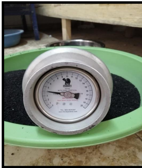
Figura 36: Lectura de humedad en el material de muestra.
