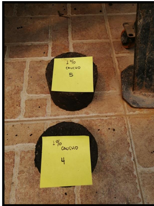
Figura 50. Adición de gránulo de caucho reciclado a la Mezcla Asfáltica Natural MAN VERDE.
