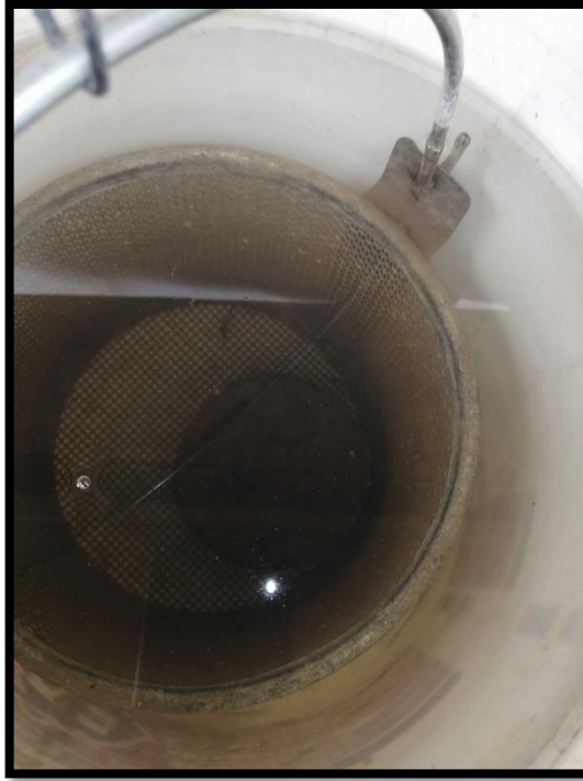
Figura 51. Briquetas en inmersión de agua a 25°C, para obtener la gravedad específica.
