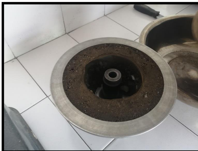
Figura 30: Copa giratoria. Sin asfalto.
