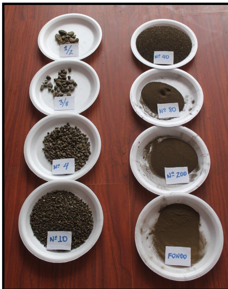
Figura 24: Porcentajes que pasan cada uno de los tamices, de la Mezcla Asfáltica Natural (MAN).
