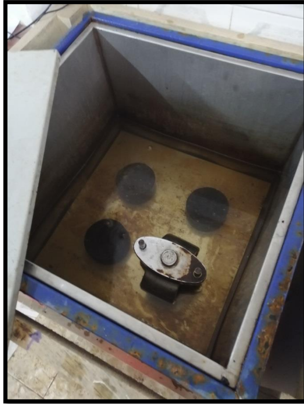
Figura 44. Briquetas sumergidas durante 4 días a una temperatura estable de 25°C, para evaluar la estabilidad residual.
