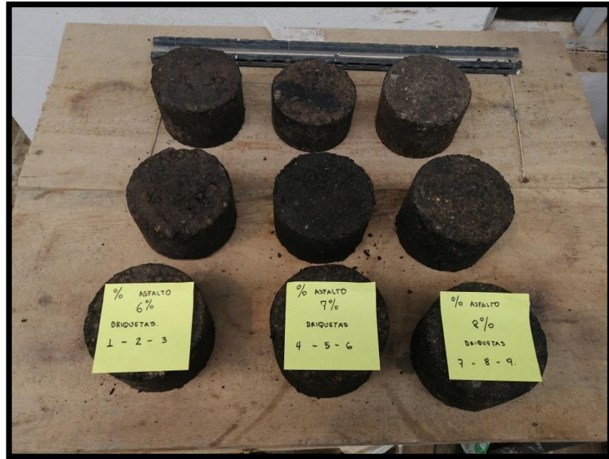
Figura 42. Lotes de briquetas preparadas con diferentes porcentajes de asfalto, para nuestra Mezcla Asfáltica Natural (MAN).
