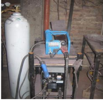
Fig5, equipo de soldadura MIG[autor]
