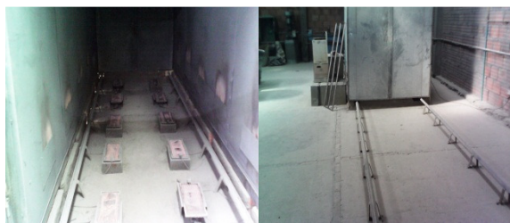
Fig.12 horno a gas propano de curado [autor]
