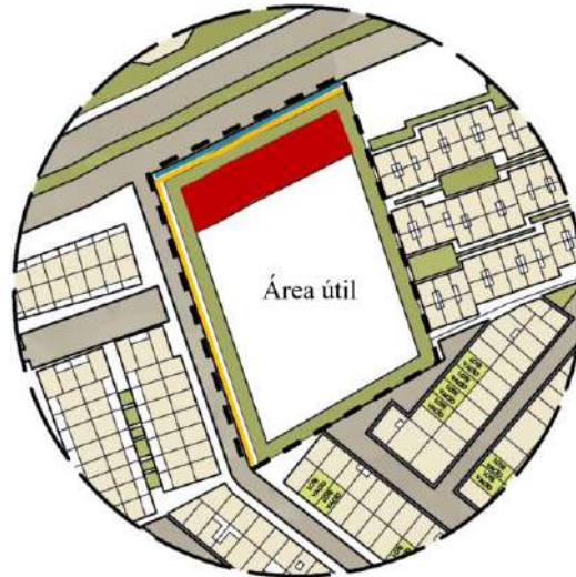
Figura 57. Aislamientos aplicados al área de intervención.
