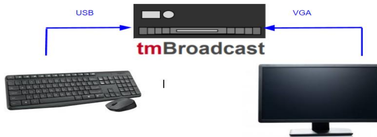
Figura 10. Conexión para programación de contenido del TmBroadcast.
