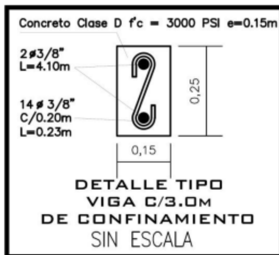
Imagen 8. Detalle varillas viga riostra
