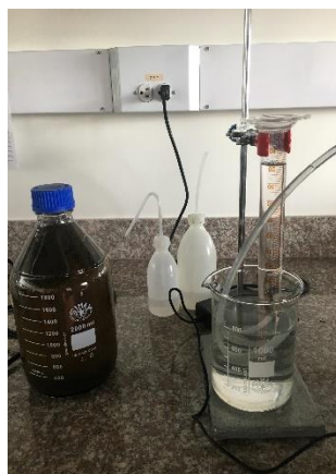
Figura 10. Medición de producción de biogás cada 3 horas en reactor de Martínez tipo Fed – Batch. Por Padilla L, 2019.
