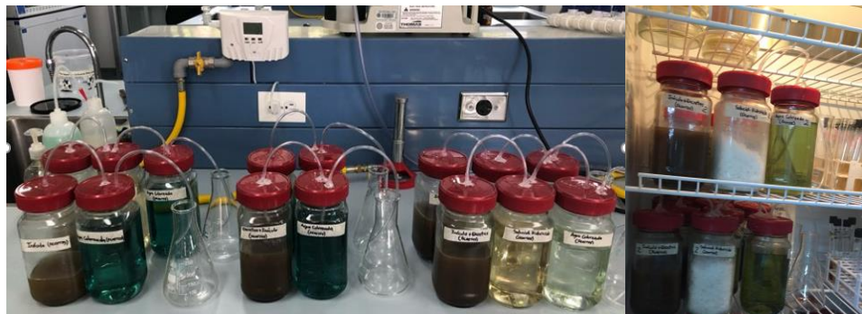
Figura 8. Montaje experimental realizado para la obtención de biogás y metano. Por Ávila D, 2019.
