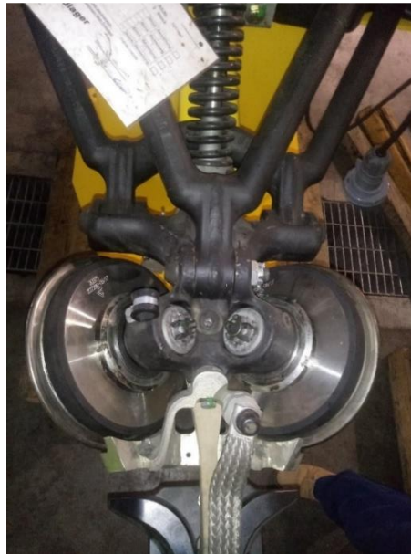
Ilustración 18 Ruedas de sistema Translöhrr.
