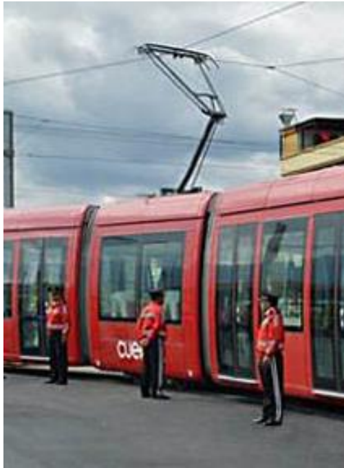
Ilustración 15 Pantógrafo Tranvía de Cuenca
