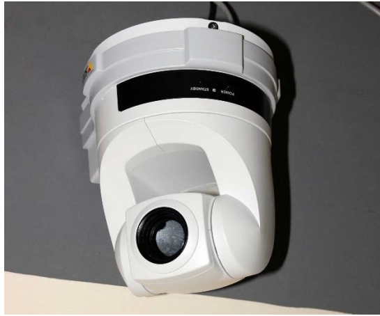
Ilustración 18 Cámara tipo PTZ.
