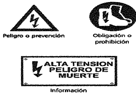
Fig. 3 Señales de seguridad colores
