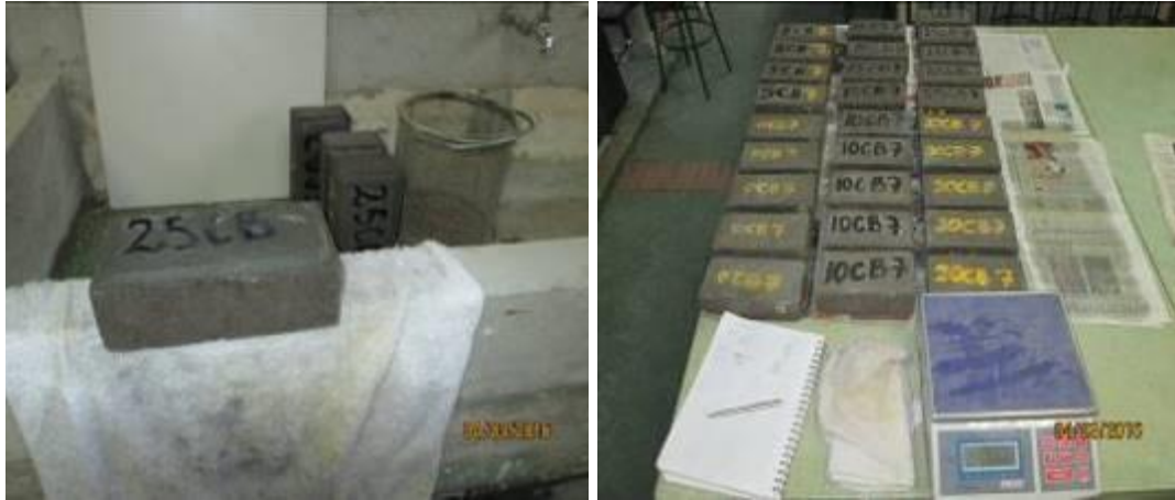
Figura 39. Obtención de masa saturada (Mh).
