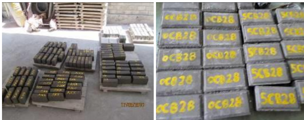
Figura 32. Marcado y codificación de los adoquines.
