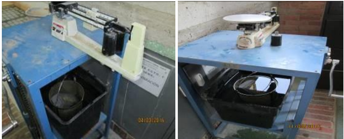
Figura 38. Obtención de masa inmersa (Ma).
