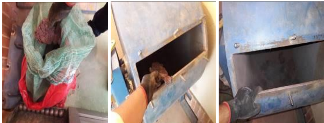
Figura 22. Trituración de cenizas de biosólido (Maquina de los Ángeles).
