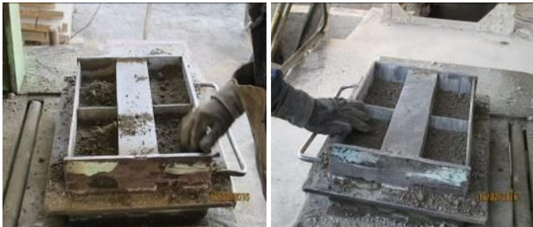
Figura 29. Aplicación bicapa y extendido uniforme de mezcla.
