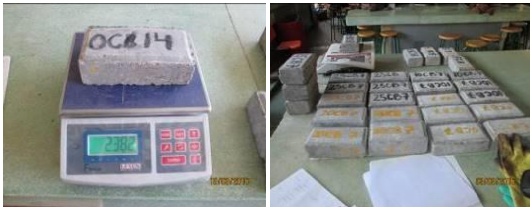
Figura 36. Obtención de la masa seca y Enfriamiento a temperatura ambiente.
