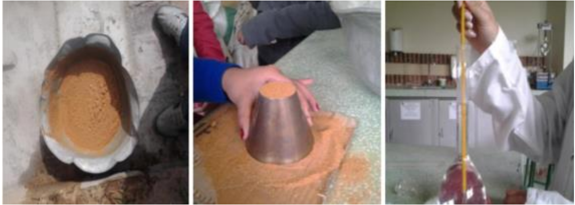
Figura 16. Prueba de absorción y densidad de arena.
