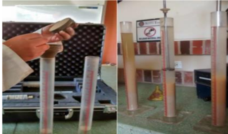
Figura 18. Prueba equivalente de arena.
