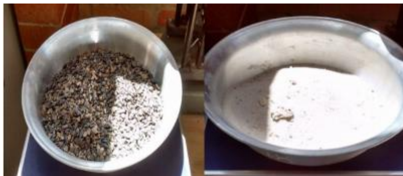
Figura 14. Agregados, Granito y Arena.
