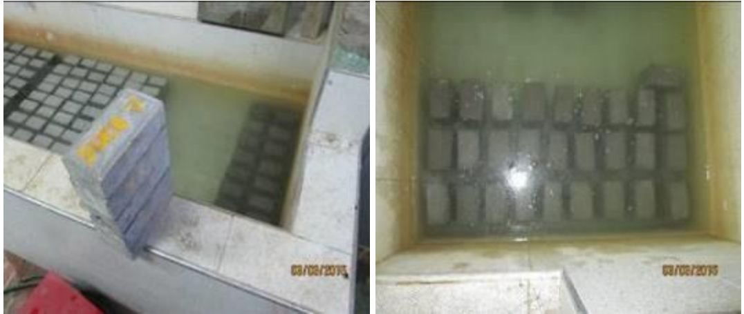
Figura 37. Adoquines sumergidos 24h, para pruebas de (Ma y Mh).
