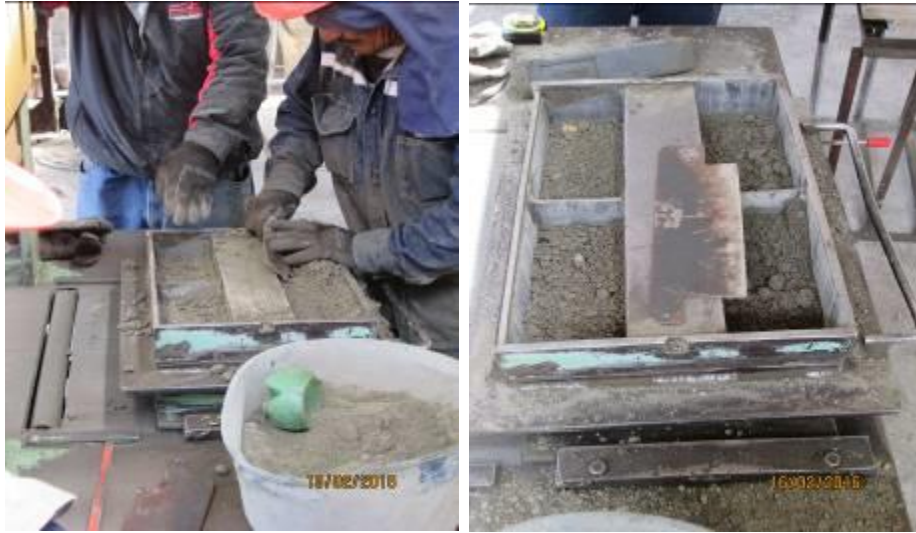
Figura 28. Vaciado y extendido de mezcla.
