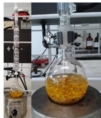
Desengrase de cáscara de mandarina empleando un equipo Soxhlet
