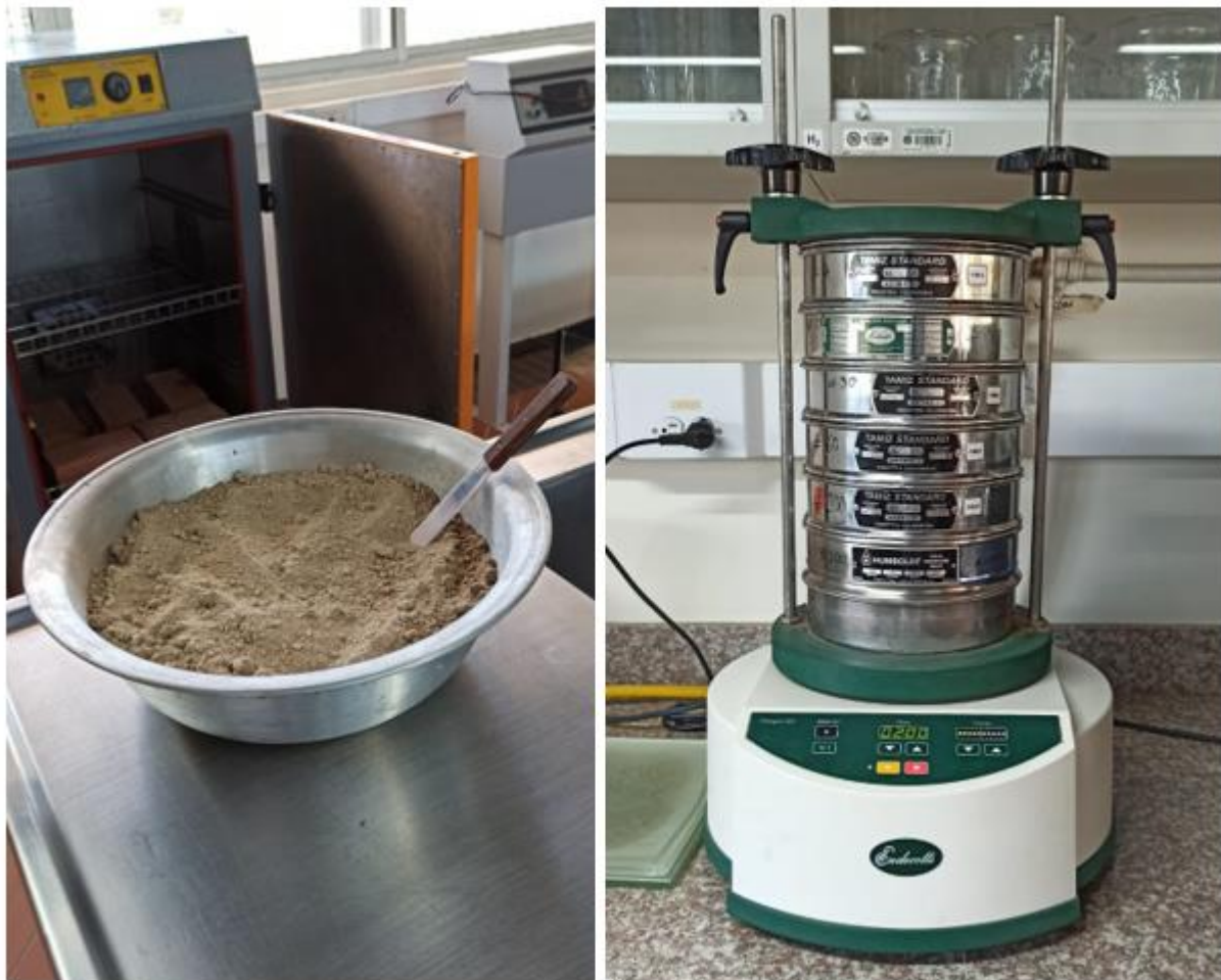
Figura 8 Ensayo de granulometría para agregados
