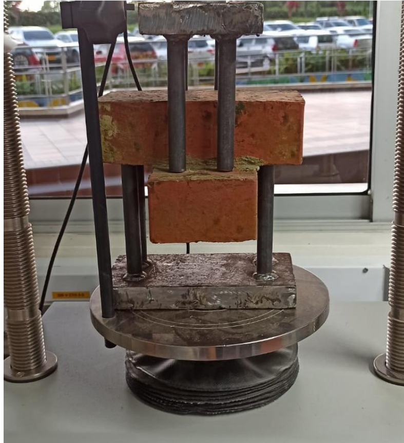
Figura 22 Ensayo de adherencia por tracción directa
