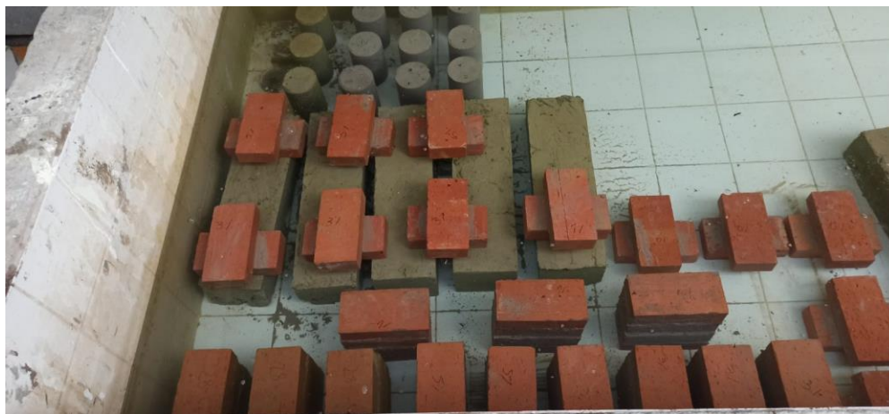
Figura 15 Curado de las muestras para el ensayo de adherencia
