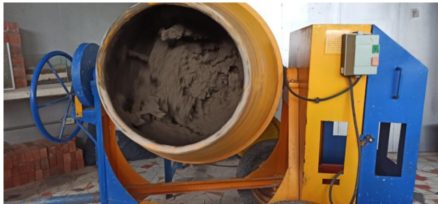
Figura 9 Mezcla del mortero tradicional
