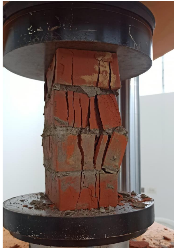
Figura 20 Ensayo de resistencia de muretes de mampostería a compresión
