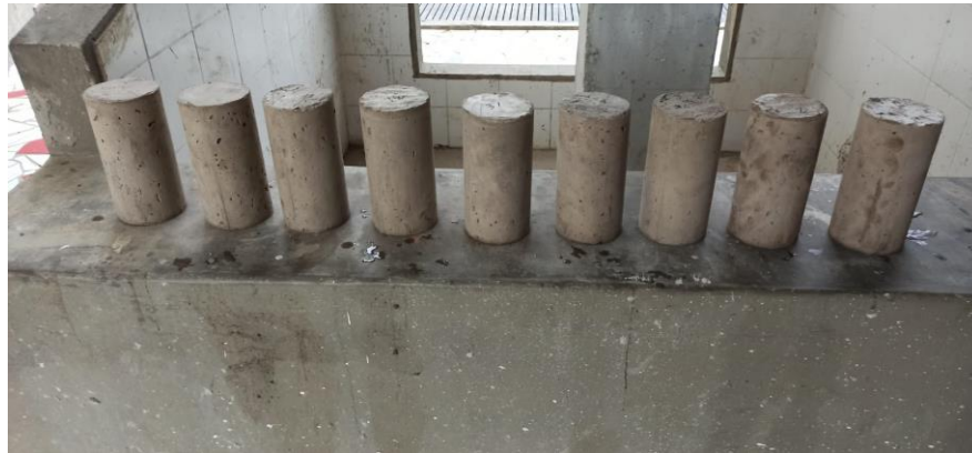
Figura 11 Cilindros de mortero con 1, 3 y 5% de resina epóxica
