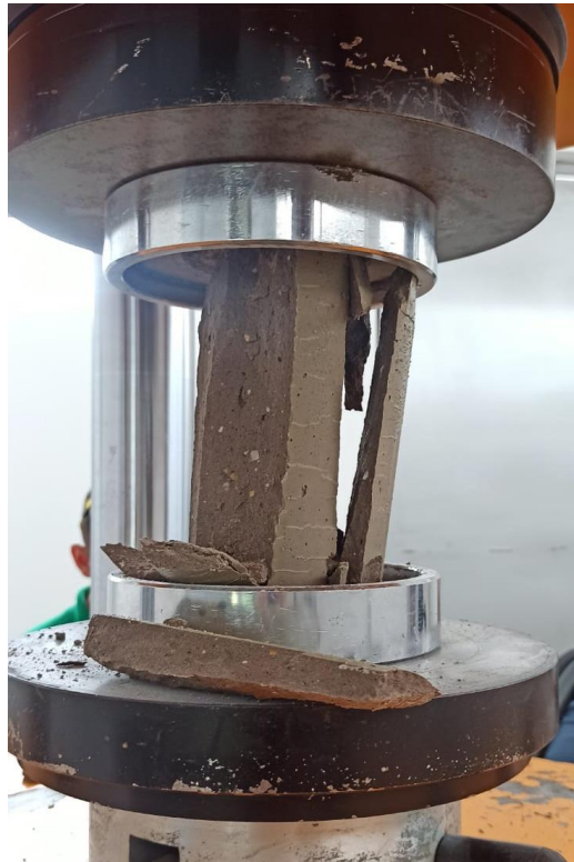
Figura 18 Ensayo de cilindro de mortero
