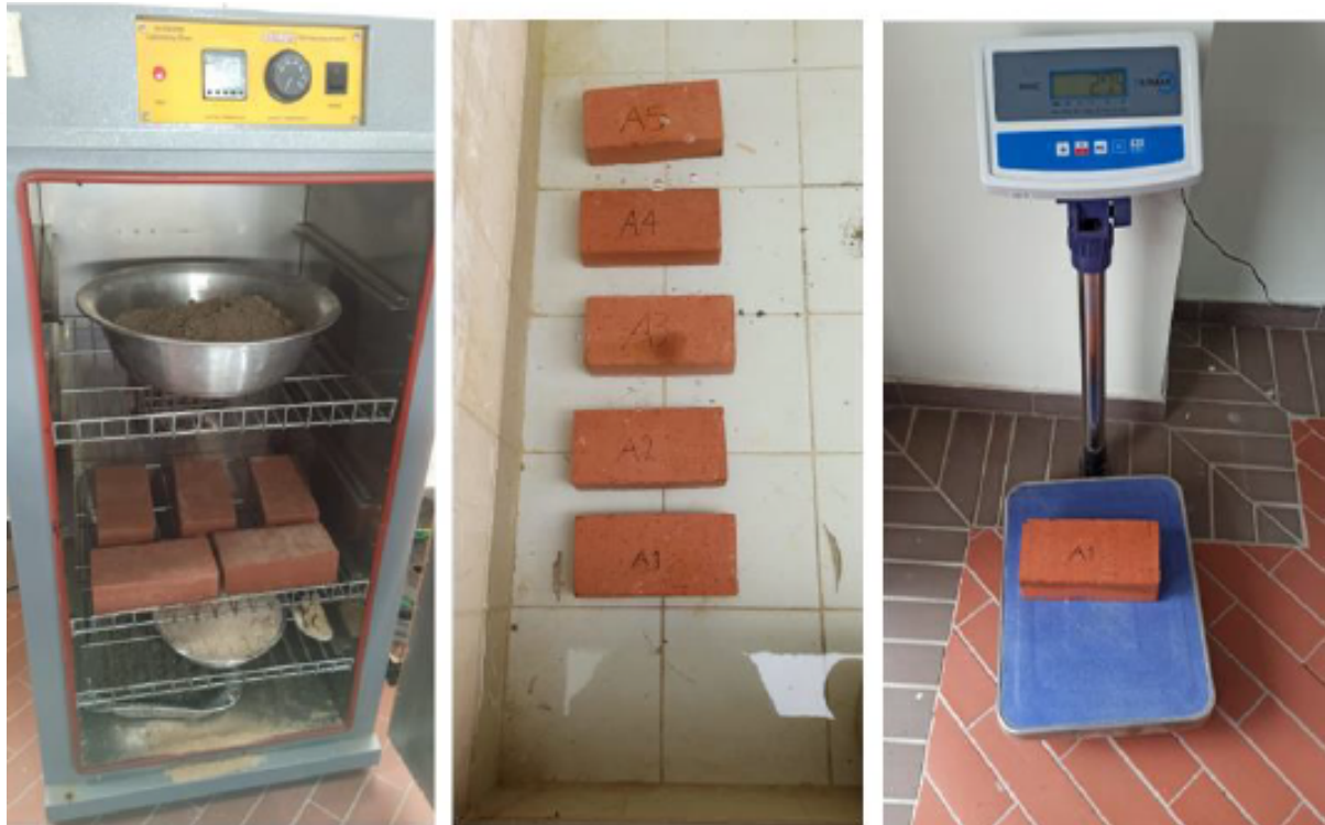
Figura 7 Ensayo de absorción de unidades de mampostería
