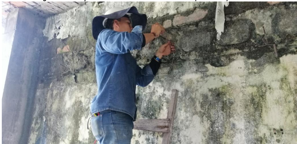
Figura 14 Ensayo de esclerometría en el sitio N° 2 placa Bloque Anterior
