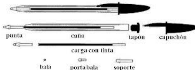
Ilustración 13. Morfología del bolígrafo bic cristal.
